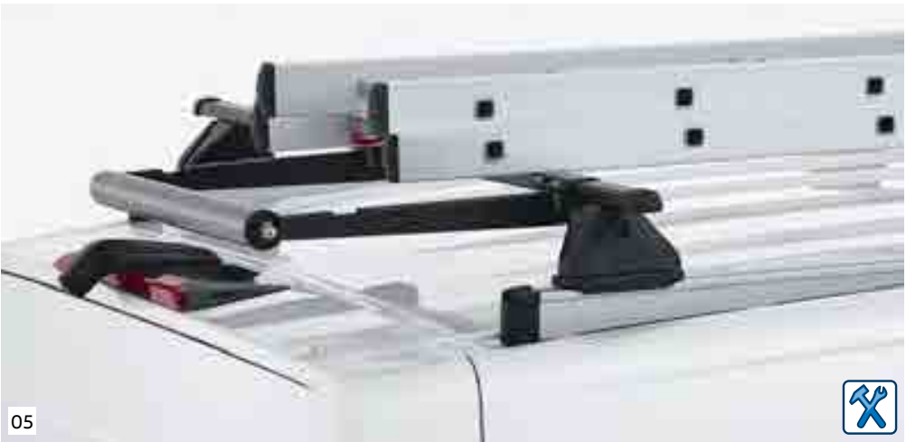
05 Rodillo de rodadura. Este suave rodillo se instala en la última de las barras de techo. Con él, cargar el techo con una carga voluminosa es un juego de niños. Después de colocarlas en el rodillo, las escaleras se pueden empujar sin esfuerzo, sin arañar la pintura o dejar marcas antiestéticas. Solo se puede utilizar junto con las barras de soporte.
