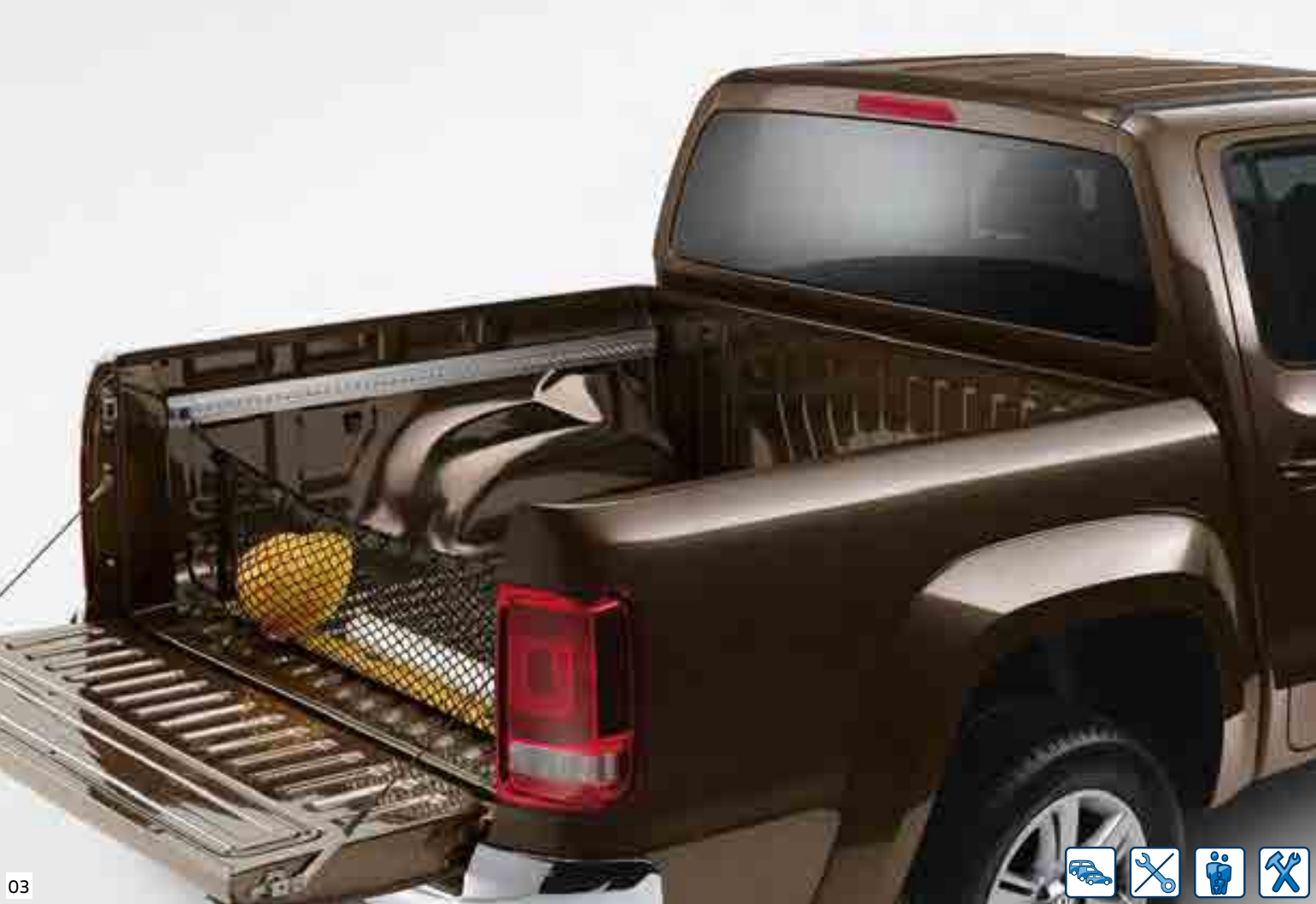
03 Sistema de raíles. El sistema de raíles puede ocuparse de cualquier transporte gracias a los raíles universales laterales y del suelo. Los juegos para las paredes laterales y la superficie de carga consisten cada uno en dos perfiles de raíl y cuatro conexiones de correa de amarre. Los raíles pueden usarse con una amplia gama de accesorios, como correas, redes de carga y barras de soporte. Esto permite que la carga quede bien asegurada y sin riesgo alguno de deslizarse por la zona de carga. Consulta la lista de precios para obtener un resumen de todas las versiones disponibles.
